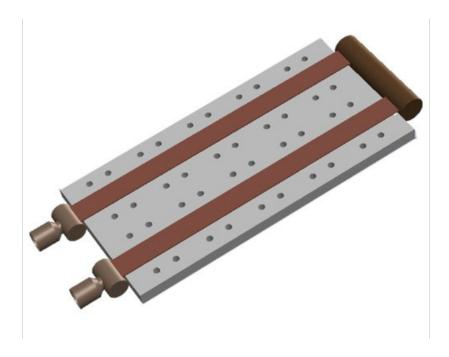
一套典型的水冷散热系统必须具有以下部件:水冷块、循环液、水泵、管道和水箱或换热器。水冷块是一个内部留有水道的金属块,由铜或铝制成,与CPU接触并将吸收CPU的热量。循环液由水泵的作用在循环的管路中流动,如果液体是水,就是我们俗称的水冷系统。吸收了CPU热量的液体就会从CPU上的水冷块中流走,而新的低温的循环液将继续吸收CPU的热量。水管连接水泵、水冷块和水箱,其作用是让循环液在一个密闭的通道中循环流动而不外漏,让液冷散热系统正常工作。水箱用来存储循环液,换热器就是一个类似散热片的装置,循环液将热量传递给具有大表面积的散热片,散热片上的风扇则将流入空气的热量带走。
