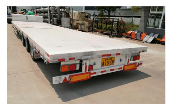
气垫车运输的明显特点,是通过全车气囊减振系统,使得车上的货物在X轴、Y轴、Z轴三维方向的振动值均控制在一定范围(1个加速度)内,避免车辆刹车前冲力和转弯造成的纵向倾斜,防止货物振动超过允许标准而受损。在此基础上特制防振气垫车,可将车内震动小于15G□倾斜度小于30°,使用于光电光伏类设备及玻璃基板运输,精密仪器,医疗器械的运输,从而对产品的稳定性,安全性,成品率较大提高□X性有很关键的作用。随着电子设备日趋不错化,为了避免在运输过程中造成不必要的破损。翱诚引进了具有二十一世纪X水平的气垫车,其减震性能、装载能力及操作系统均属X□即提供温控气垫车,又可提既可提供20英尺、40英尺、48英尺集装箱气垫车、低平板气垫车、普通平板气垫车。
